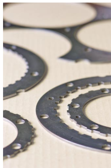
Die Byjet schneidet präzise Teile innerhalb einer Toleranz von plus/minus 1 Zehntelmillimeter.
