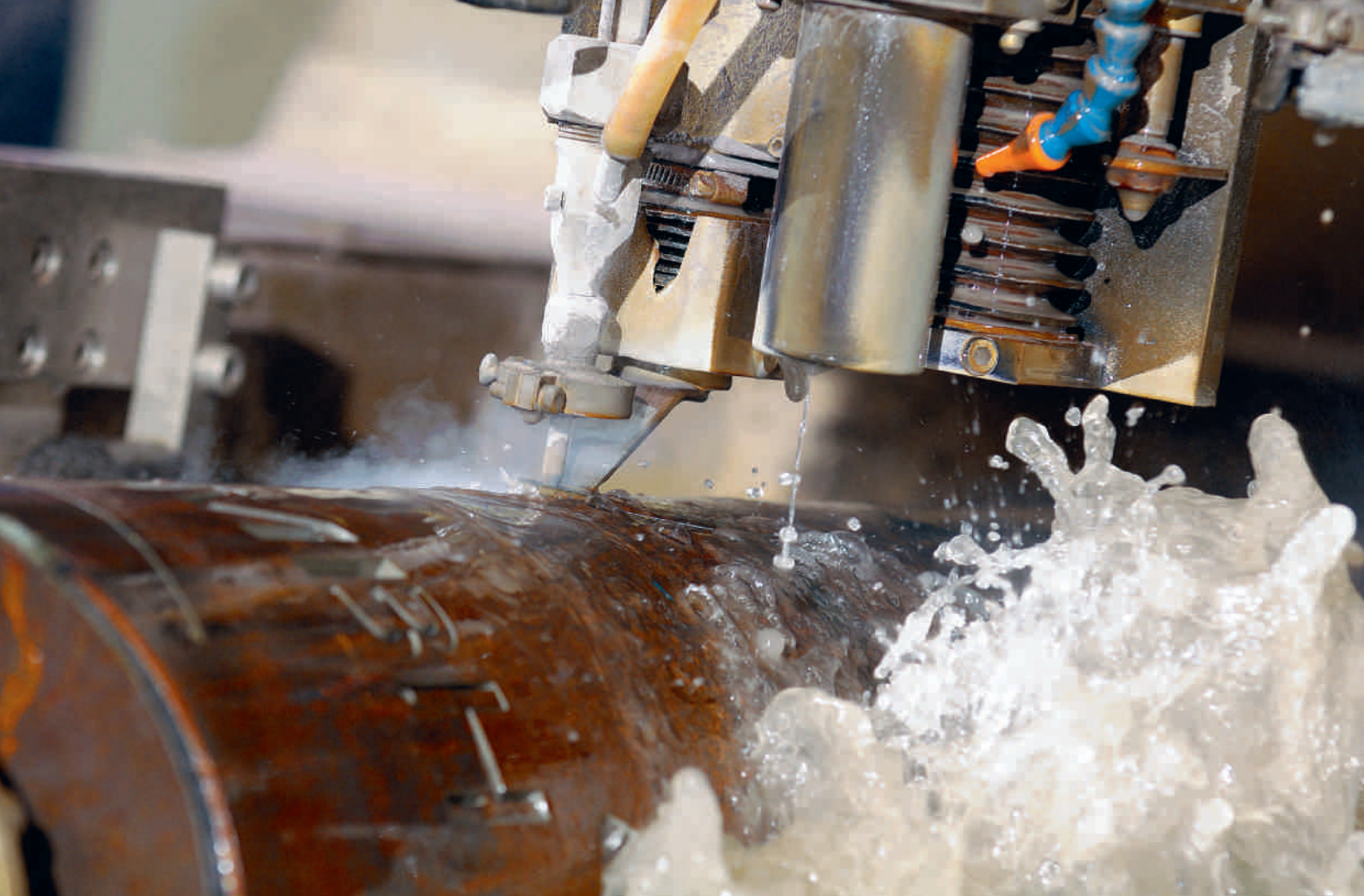
Mit der optionalen Drehachse werden auch Rund- und Profilteile bearbeitet. Die ByJet Pro L ist äußerst einfach zu handhaben.
