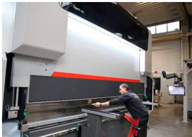
Mit 250 Tonnen Presskraft und einer Biegelänge von vier Metern bietet die Xpert 250 ein breites Anwendungsspektrum .
