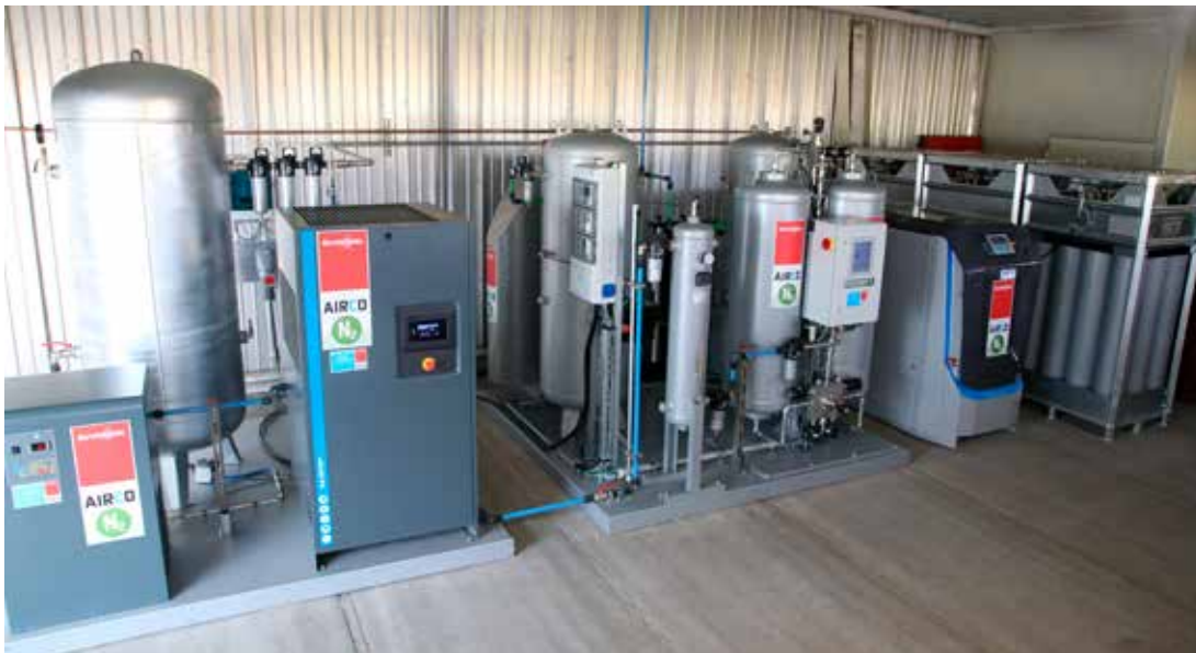
Mit dem Stickstoffgenerator erzeugt Baumann den benötigten Stickstoff für die Lasermaschine selbst.
