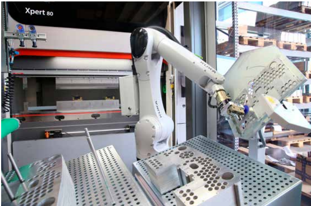
In der Zentrierstation wird das Bauteil für das Biegen in die korrekte Position gebracht.
