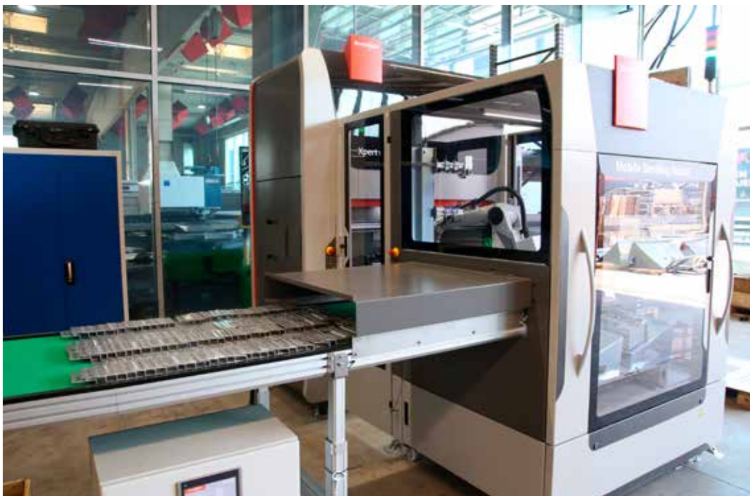
Das drei Meter lange Förderband gewährleistet, dass die gebogenen Teile beim Abtransport unbeschädigt (kratzerfrei) bleiben.
