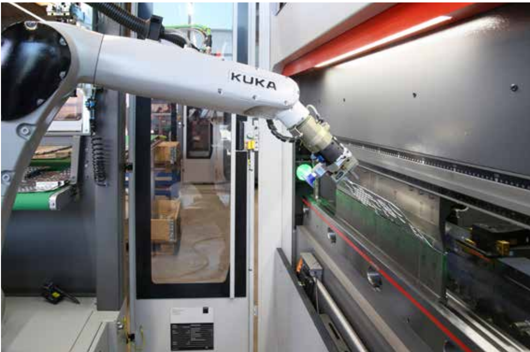
Der Biegeroboter überzeugt mit maximaler Wiederholgenauigkeit und sorgt damit bei Terschls beim automatisierten Biegen für eine Ausschussquote gegen Null.
